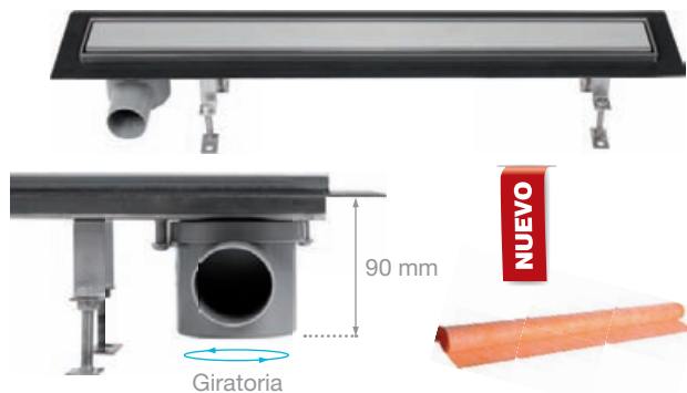
Canaleta Brillance 700 mm con válvula 75 mm · Fabricada en acero inoxidable AISI 304 · Válvula de 75 mm con salida a desagüe de Ø 50 mm
