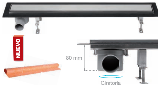
Canaleta Brillance 800 mm con válvula 65 mm · Fabricada en acero inoxidable AISI 304 · Válvula de 65 mm con salida a desagüe de Ø 50 mm
