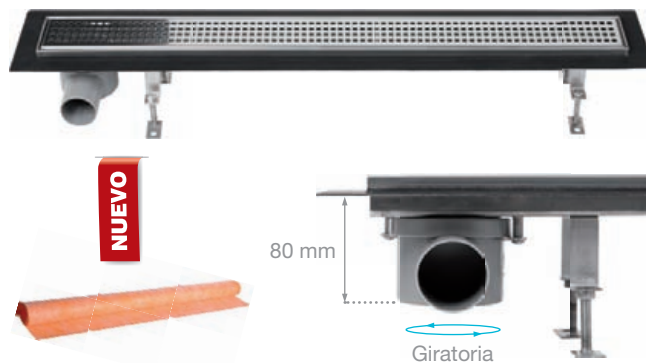
Canaleta Quadro 800 mm con válvula 65 mm · Fabricada en acero inoxidable AISI 304 · Válvula de 65 mm con salida a desagüe de Ø 50 mm
