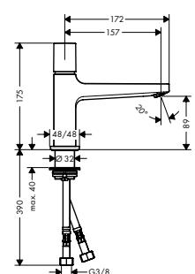
**Select mezclador de lavabo 100 con vaciador Push-Open**
