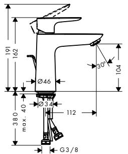
**Mezclador monomando de lavabo 110 con vaciador automático**
