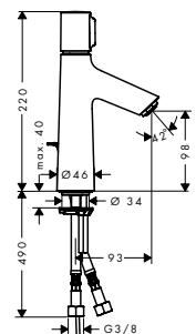
**Mezclador de lavabo 100 con vaciador automático**
