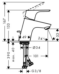
**Mezclador monomando de lavabo 70 con vaciador automático**
