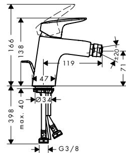
**Mezclador monomando de bidé 70 con vaciador automático**
