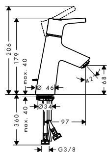
**Mezclador monomando de lavabo 80 CoolStart con vaciador automático**
