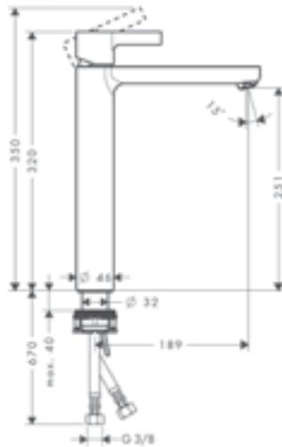
**Mezclador monomando de lavabo tipo bowl sin vaciador automático**
