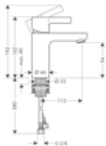
**Mezclador monomando de lavabo sin vaciador automático**
