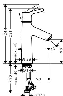
**Mezclador monomando de lavabo 100 con vaciador automático**
