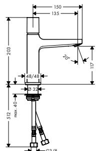
**Select mezclador de lavabo 110 con vaciador Push-Open**
