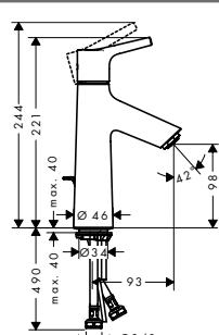
**Mezclador monomando de lavabo 100 CoolStart con vaciador automático**
