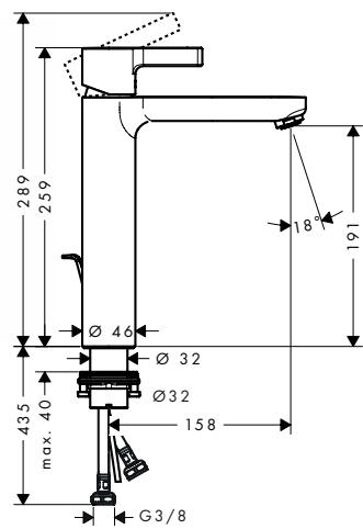
**Mezclador monomando de lavabo con vaciador automático**
