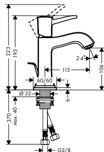
**Mezclador monomando de lavabo 110 con vaciador automático**
