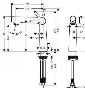
**Mezclador monomando de lavabo 140 con vaciador automático**
