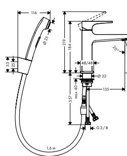
**Mezclador monomando de lavabo con teleducha de bidé con manecilla plana y vaciador Push-Open**
