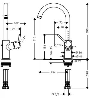
**Mezclador monomando de lavabo 210 con caño giratorio 120° y vaciador automático**
