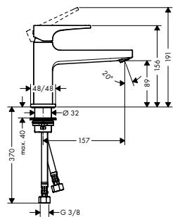
**Mezclador monomando de lavabo 100 con manecilla Loop y vaciador Push-Open**
