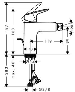
**Mezclador monomando de bidé 100 con vaciador automático**
