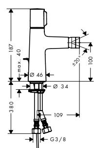
**Mezclador de bidé con vaciador automático**
