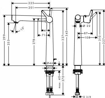
**Mezclador monomando de lavabo 250 con vaciador automático**
