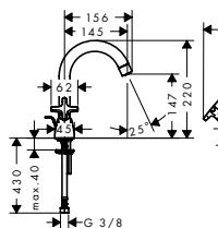
**Mezclador bimando de lavabo 150 con vaciador automático**
