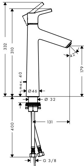
**Mezclador monomando de lavabo 190 con vaciador automático**
