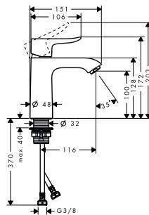
**Mezclador monomando de lavabo 110 sin vaciador automático**
