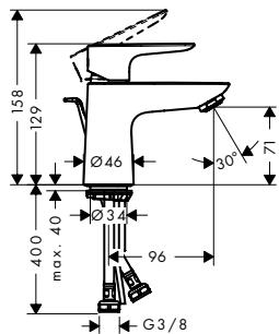
**Mezclador monomando de lavabo 80 con vaciador automático**
