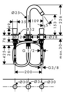
**Batería americana de lavabo con vaciador automático**
