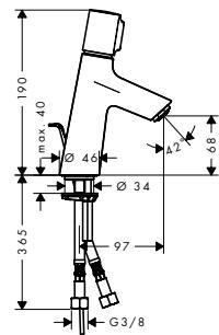
**Mezclador de lavabo 80 con vaciador automático**
