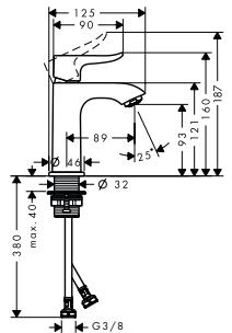
**Mezclador monomando de lavabo 100 sin vaciador automático**
