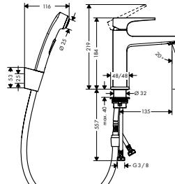
**Mezclador monomando de lavabo con teleducha de bidé con manecilla Loop y vaciador Push-Open**
