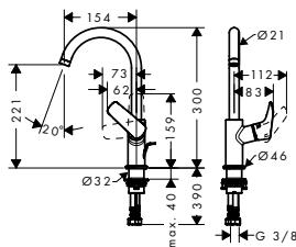
**Mezclador monomando de lavabo 210 con caño giratorio 120° y vaciador automático**
