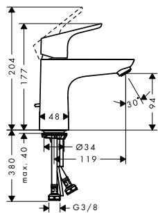
**Mezclador monomando de lavabo 100 con vaciador automático**
