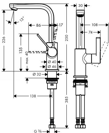
**Mezclador monomando de lavabo con vaciador Push-Open**
