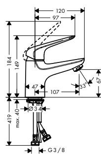
**Mezclador monomando de lavabo 70 CoolStart con vaciador Push-open**
