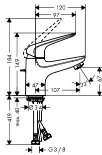
**Mezclador monomando de lavabo 70 con vaciador automático**
