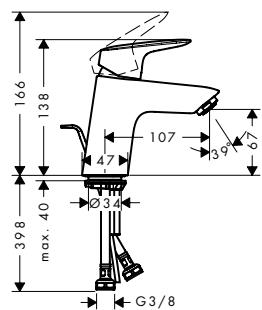
**Mezclador monomando de lavabo 70 CoolStart con vaciador automático**
