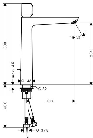
**Mezclador de lavabo 240 con vaciador automático**
