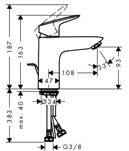
**Mezclador monomando de lavabo 100 con vaciador automático**
