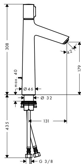
**Mezclador de lavabo 190 con vaciador automático**
