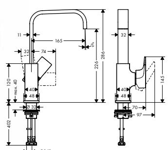
**Mezclador monomando de lavabo 230 con manecilla plana y vaciador Push-Open**
