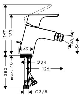
**Mezclador monomando de bidé con vaciador automático**
