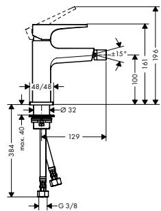
**Mezclador monomando de bidé con manecilla plana y vaciador Push-Open**
