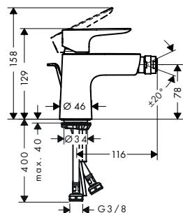
**Mezclador monomando de bidé con vaciador automático**
