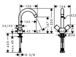
**Mezclador bimando de lavabo con vaciador automático**
