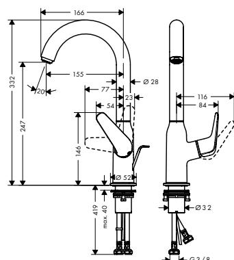
**Mezclador monomando de lavabo 240 con caño giratorio 120° y vaciador automático**
