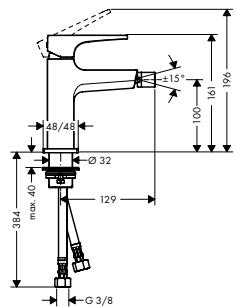
**Mezclador monomando de bidé con manecilla Loop y vaciador Push-Open**
