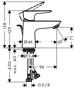
**Mezclador monomando de lavabo 80 CoolStart con vaciador automático**
