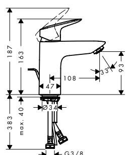
**Mezclador monomando de lavabo 100 CoolStart con vaciador automático**
