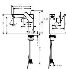
**Mezclador monomando de lavabo 150 con vaciador automático**
