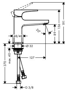
**Mezclador monomando de lavabo 100 con manecilla plana y vaciador Push-Open**
