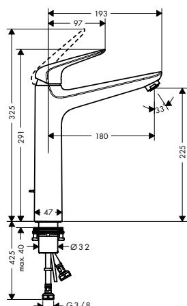
**Mezclador monomando de lavabo 230 con vaciador automático**
