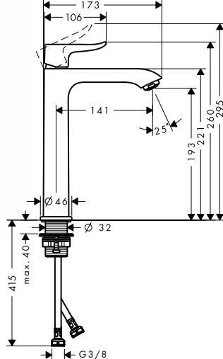
**Mezclador monomando de lavabo 200 sin vaciador automático**
