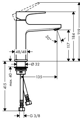
**Mezclador monomando de lavabo 110 con manecilla plana y vaciador Push-Open**
