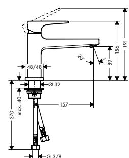
**Mezclador monomando de lavabo 100 con manecilla plana y vaciador Push-Open**
