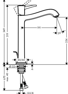
**Mezclador monomando de lavabo 260 con vaciador automático**
