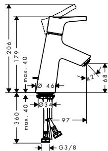
**Mezclador monomando de lavabo 80 con vaciador automático**
