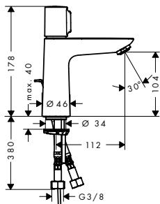
**Mezclador de lavabo 110 con vaciador automático**
