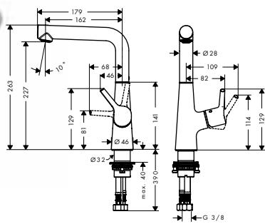
**Mezclador monomando de lavabo 210 con caño giratorio 120° y vaciador automático**
