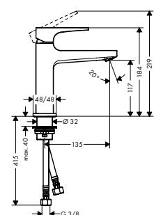
**Mezclador monomando de lavabo 110 con manecilla Loop y vaciador Push-Open**
