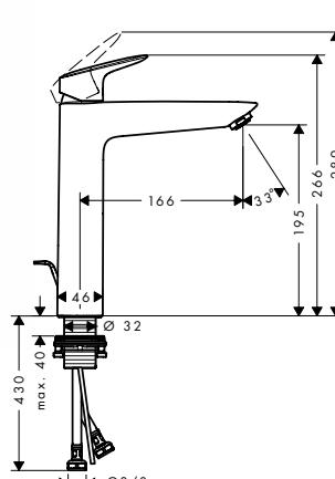
**Mezclador monomando de lavabo 190 con vaciador automático**
