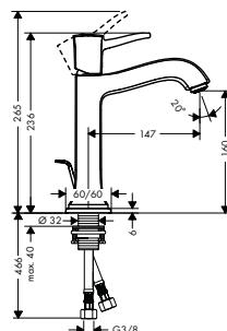
**Mezclador monomando de lavabo 160 con vaciador automático**
