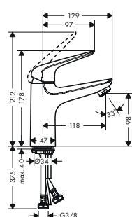
**Mezclador monomando de lavabo 100 CoolStart con vaciador Push-Open**
