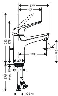
**Mezclador monomando de lavabo 100 con vaciador automático**
