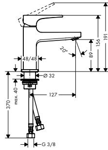
**Mezclador monomando de lavabo 100 con manecilla Loop y vaciador Push-Open**
